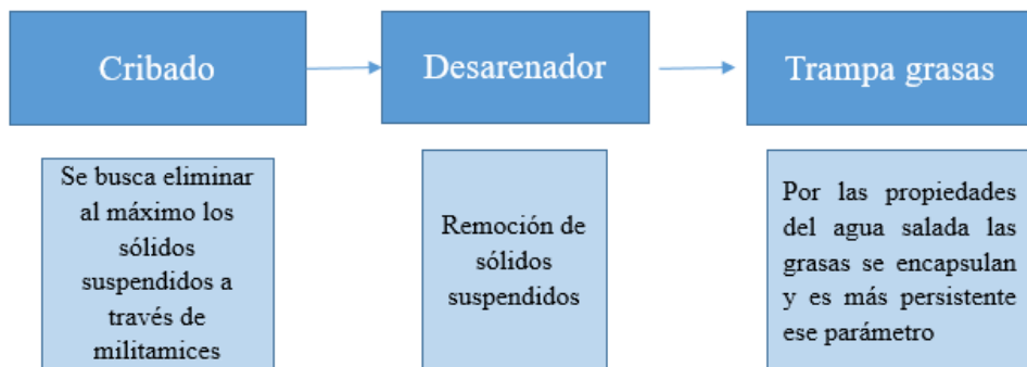
Figura 2. Secuencia de operaciones unitarias requeridas para una PTAR que dispone en medio marítimo
