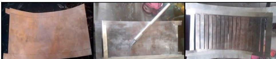
Figura 8. Proceso de corte del aluminio en patrón de escalera
